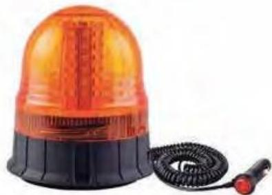
Homologación ECE R10, que regula la compatibilidad electromagnética. Color Ámbar. Tulipa de Policarbonato ultra resistente. Voltaje: 12/24 V. Secuencias: Con selector 3 secuencias interior. Números de LED: 60 LED (SMD). Montaje: Base de tres tornillos. Cable: Con interruptor en enchufe mechero.
