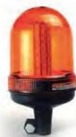
Homologación ECE R10, que regula la compatibilidad electro- magnética. Homologación ECE R65, que permite la circulación por carretera. Sujeción base fija poste. Color: Ámbar. Tulipa: Policarbonato ultra resistente. Voltaje: 12/24 V. Secuencias: Con selector 3 secuencias. Potencia máxima: 36W. Números de LED: 12 LED x 3W.
