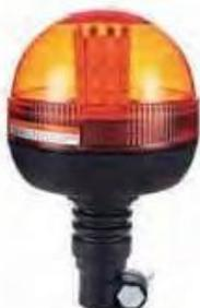
Homologación ECE R10, que regula la compatibilidad electro- magnética. Homologación ECE R65, que permite la circulación por carretera. Sujeción base fija poste. Color: Ámbar. Tulipa: Policarbonato ultra resistente. Voltaje: 12/24V. Secuencias: Con selector 3 secuencias. Potencia máxima: 36W. Números de LED: 12 LED x 3W.
